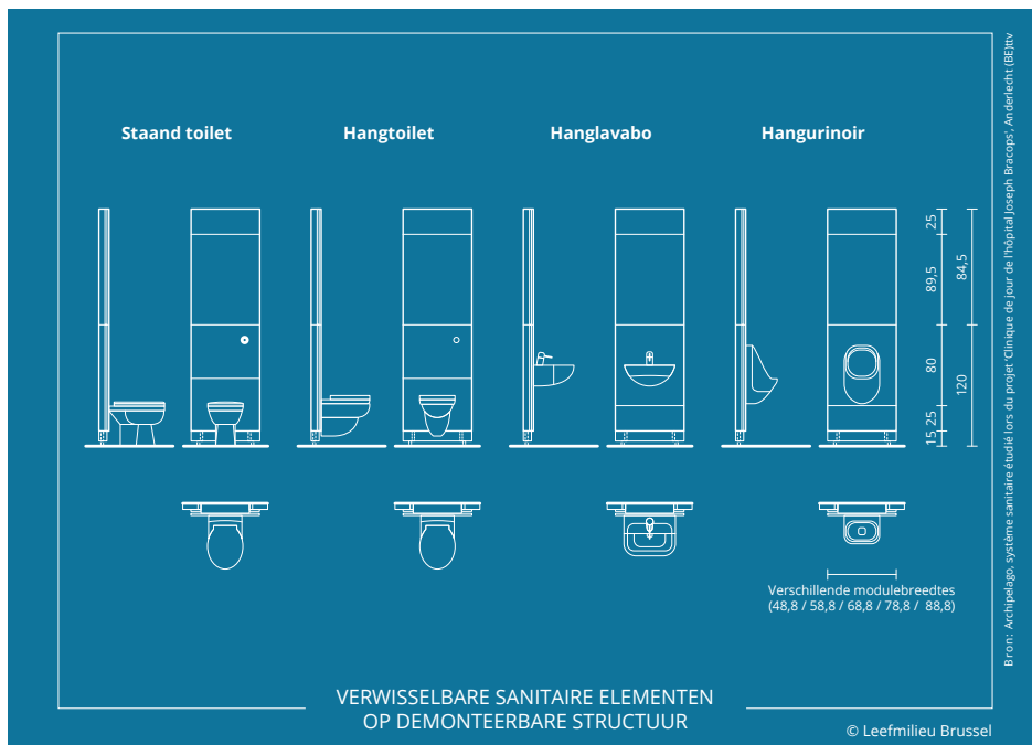
Afbeelding 46: Dit omkeerbare sanitaire systeem is voorzien in het circulaire ontwerp voor de polikliniek van Ziekenhuis Joseph Bracops in Anderlecht. (Bron: archipelago)
