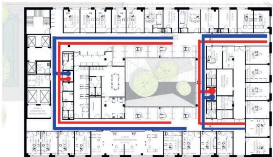
Afbeelding 148: Positie van het ventilatienetwerk (Bron: archipelago architects)
