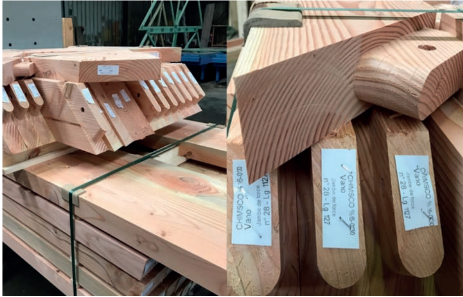
Afbeelding 95: Balkelementen verbonden met een pen- en gatverbinding. (Bron: Caroline Morizur, efp)
