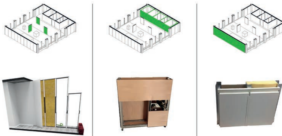
Afbeelding 102: Van links naar rechts: een systeem met klittenbandverbindingen (Bron: Architectural Engineering, VUB; Juunoo), een kit-of-parts systeem (Bron: Geberit) en een profielsysteem (Bron: Architectural Engineering, VUB; Saint-Gobain)
