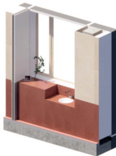
Afbeelding 154: Een modulair element, waarin wastafels geïntegreerd zijn. (Bron: archipelago architects)
