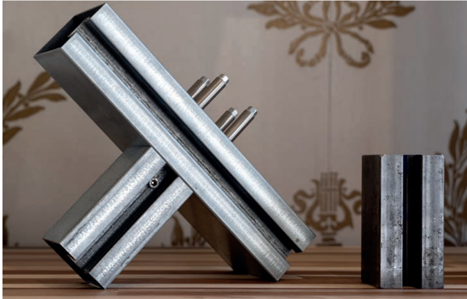
Afbeelding 135: foto van een detail van een Jansen VISS-stijlen -regel voorzien van een demontabele, universele T-verbinding, een mechanische verbinding die voor Jansen VISS-profielen werd ontwikkeld maar ook op standaard stalen buisprofielen past. Ideaal voor circulaire toepassingen. (Bron: Tim Fisher)
